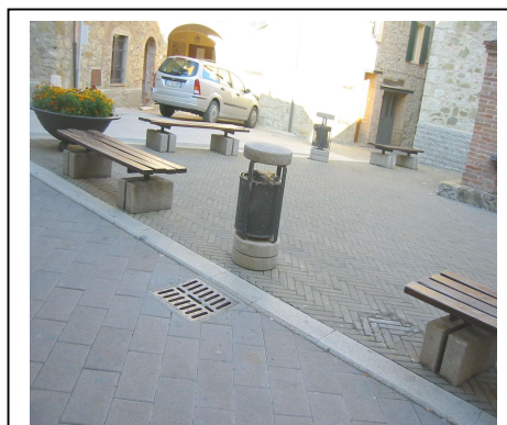
Esempio di delimitazione di spazi pedonali da quelli per il transito dei veicoli attraverso la sola differenziazione della pavimentazione.
