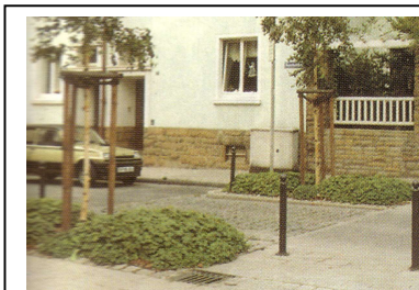
Impianto di nuovi alberi in strade residenziali a traffico moderato con tutori in legno e arbusti nella fascia alberata.
